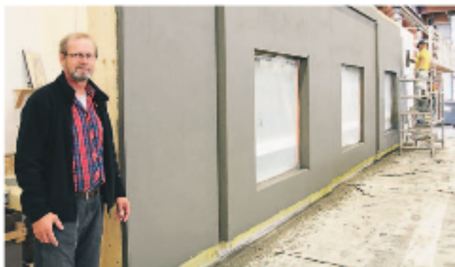
▲ Saneerauselementti on nyt rappauspintainen, mutta pinta voi olla mitä tahansa materiaalia paitsi muurattu tiili ei sovellu. Toimitusjohtaja Pauli Parviainen pitääkin tärkeänä, että puuta yhdistetään tarvittaessa muihin rakennusmateriaaleihin.
