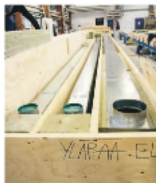
▲ Huoneistokohtaiset ilmastointikanavat asennetaan valmiiksi elementin sisään tehtaalla.
